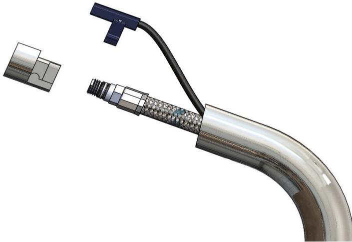
6. 將電路組、起泡頭組、高壓軟管 移出水龍頭.
