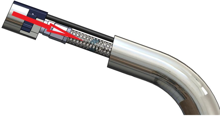
12. 將起泡頭組旋至水龍頭定位孔，用六角板手固定即可。
