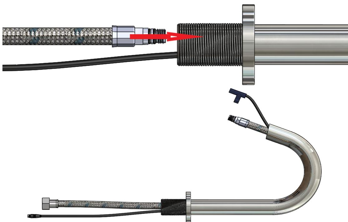
9. 依反程序將起泡頭組與高壓軟管結合.(注意：此處請確實旋入, 否則將會漏水)
