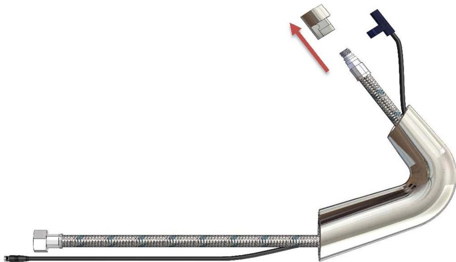
6. 將電路組、起泡頭組、高壓軟管 移出水龍頭.
