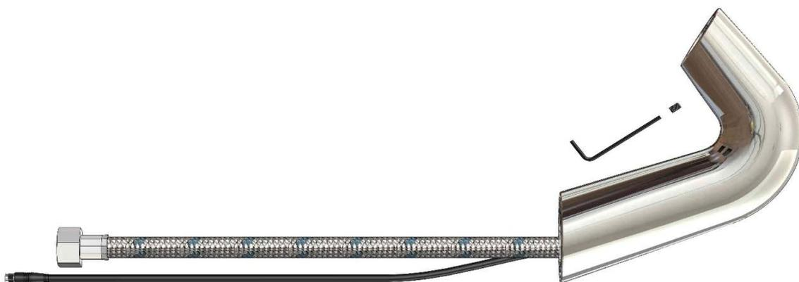
3. 將下方高壓軟管往上推，即可將電路組&起泡頭組推出.
