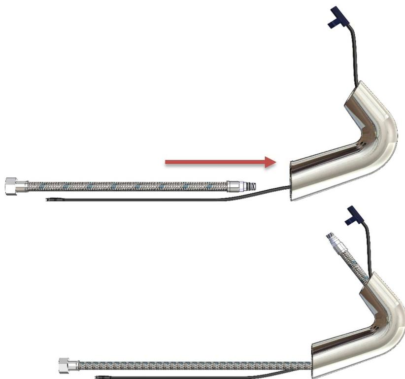
9. 依反程序將起泡頭組與高壓軟管結合.(注意：此處請確實旋入, 否則將會漏水)
