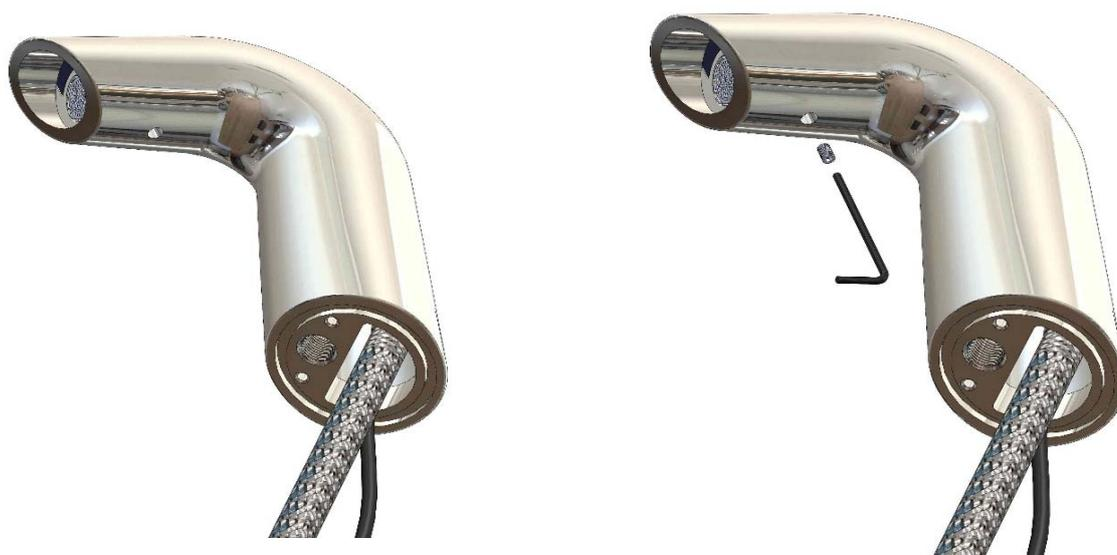
13. 新電路更換完成,請依反程序將龍頭組固定回檯面上
