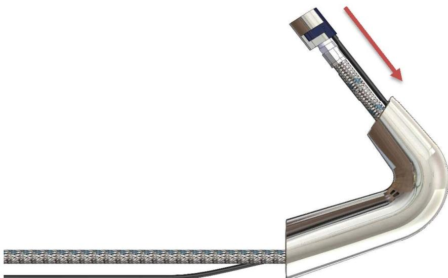
12. 將起泡頭組旋至水龍頭定位孔，用六角板手固定即可。
